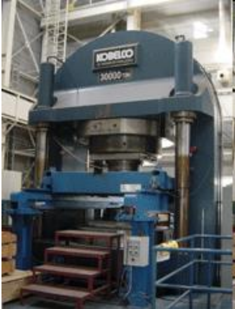
Pressa per la sintesi del diamante artificiale © Kobelco, anni '80
