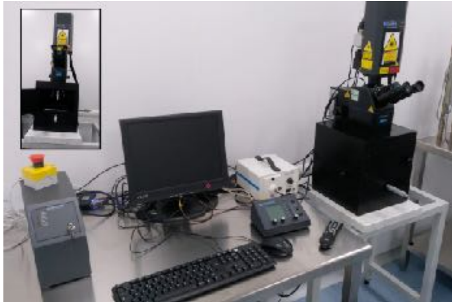
Sistema di litografia con laser ad alta potenza Fabbricazione di campioni ed elettrodi metallici
