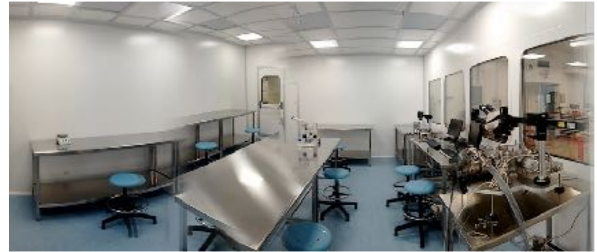
Camera pulita: 24 m 2 condizioni ambientali controllate Classe 10000: meno di 3000 particelle di polvere per m 3
