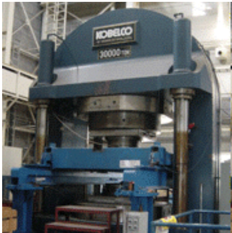
Pressa per la sintesi @ Kobelco, anni '80 Temperatura: 3000 °C, Pressione. 3.5 GPa
